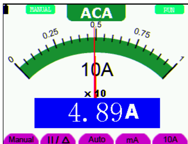
Figura 11: Medición de corriente CA para 10A
