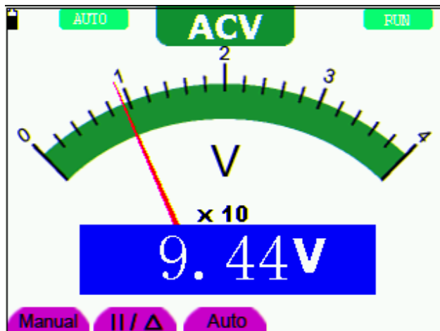
Figura 7: Medición de voltaje CA
