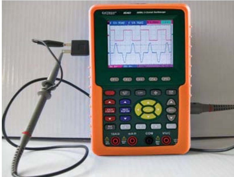
Fig 39: Señal de prueba de onda cuadrada
